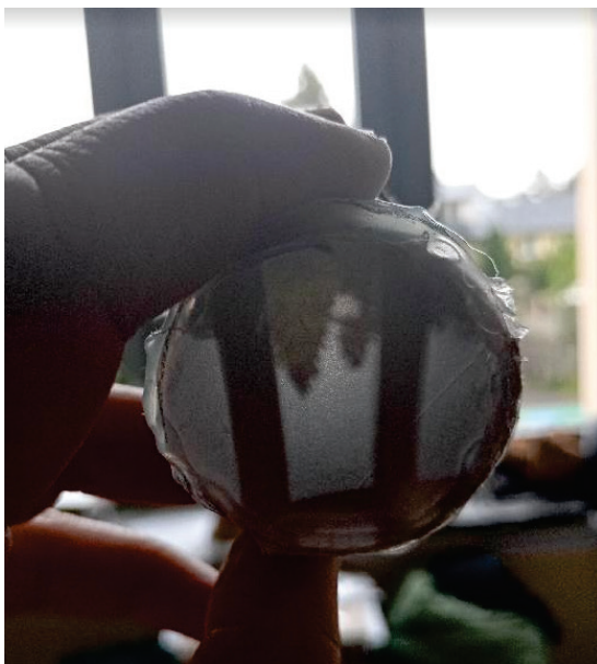
Obr. 13. Pohled z okna modelem oka s čočkou. Na matnici je vidět převrácený obraz.
