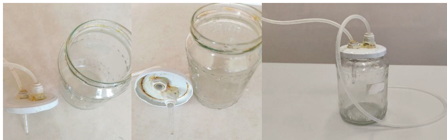
Obr. 3. Podtlaková fontána – její sestavení a použití.
