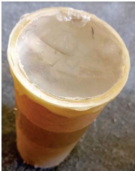
Obr. 12. „Objektiv“ oka tvořený nalepenou čočkou spojkou
