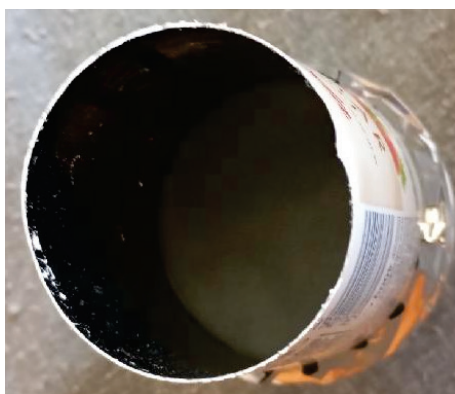
Obr. 6. Pozorovací část modelu oka. Tato strana slouží jako stínítko matnice.
