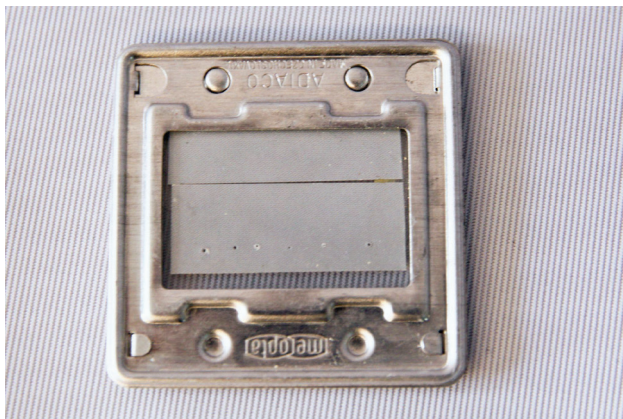
Obr. 7. Štěrbina ve tvaru klínu a kruhové otvory v papíru vložené do diapozitivu.
